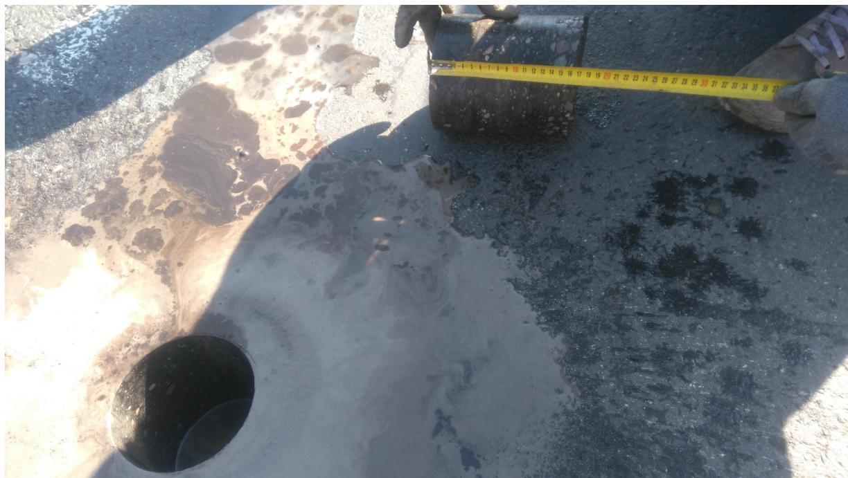
Zdjęcie 5. Profil konstrukcji nawierzchni w punkcie badawczym nr 5
