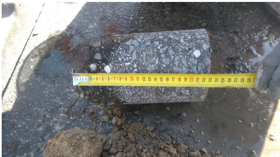
Zdjęcie 2. Profil konstrukcji nawierzchni w punkcie badawczym nr 2.
