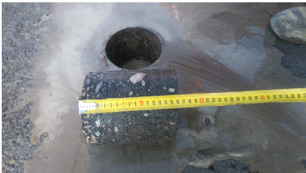
Zdjęcie 1. Profil konstrukcji nawierzchni w punkcie badawczym nr 1.
